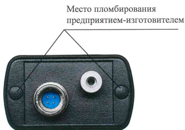
Рисунок 2 — Схема пломбировки от несанкционированного доступа
